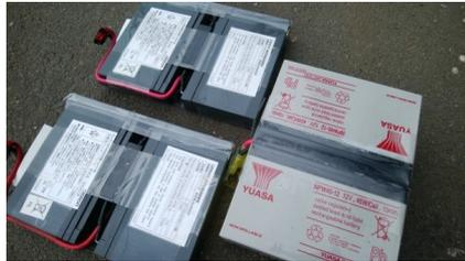
UPS用のバッテリーは、上の写真のようにプラスチックやケーブルでつながってる事がありますが、全て外すようお願いします。(ケーブルは固定してなければ、引っ張れば抜けます)
